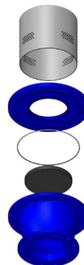
Обратный клапан пропускает среду (жидкость или газ) только в одном направлении. Важным параметром работы клапана является давление открытия, т.е. минимальное давление, при котором клапан будет работать.
